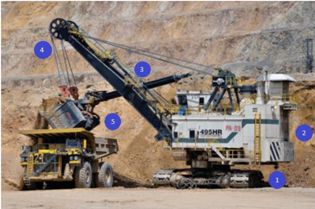
**Ilustración 3:** Muestra el proceso de carguío y transporte de mineral de la compañía minera, donde se representa 1: Infraestructura, 2: Estructura Superior, 3: Mecanismo empuje retroceso, 4: Mecanismo de levante y 5: Mecanismo descarga de balde. (CMDIC, s.f.)
