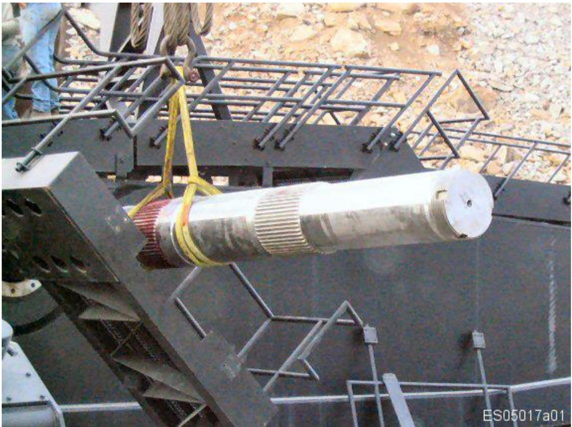
**Ilustración 10: Muestra el eje Shipper Shaft que permite el movimiento de empuje del balde. (P&H, s.f)**
