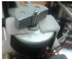
Figura 3.6: Fuente de vibración
