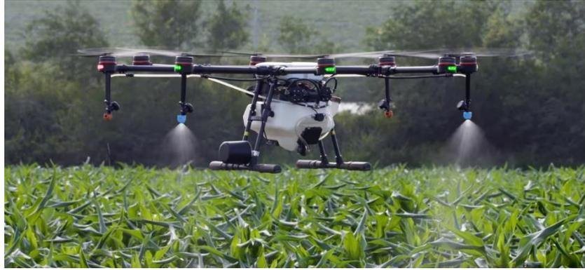
*Imagen 1 Dron Fumigador DJI AgrasT20*
