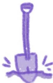
Si la pala se clava fácilmente con solo soltarla en la tierra significa que el terreno es malo, tendrás que usar fundaciones más profundas y anchas o una Losa de Fundación (Es una placa de hormigón del mismo tamaño que la superficie de la construcción. Así el peso se distribuye de igual forma evitando asentamientos y hundimientos en el terreno).
