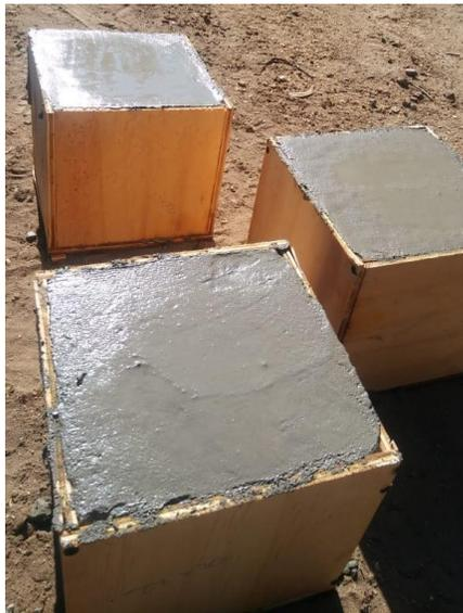
7. Con las probetas alisadas comienza un primer proceso de curado en el cual las probetas permanecen 48 horas en el mismo lugar antes de ser desmoldadas.
