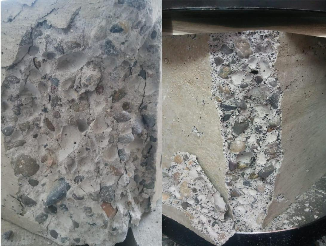
Fuente: Ensayo de compresión, Laboratorio de Construcción USM JMC.
