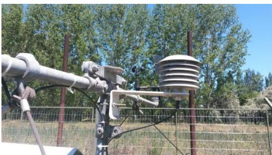
Foto 3: Sensor Temperatura y Humedad.-
