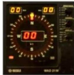
**Figura 1.7:** INDICADOR PARA SISTEMAS DE VIENTO.-
