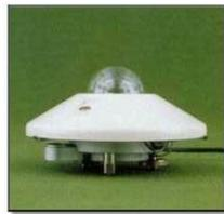
**Figura 1.1:** PIRANÓMETRO RADIACIÓN SOLAR GLOBAL.-
