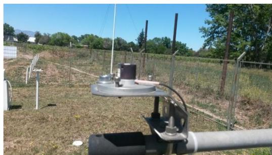
Foto 5: Sensor de Radiación Solar.-
