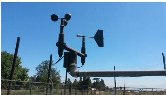
Foto 4: Sensor Velocidad y Dirección del Viento.-
