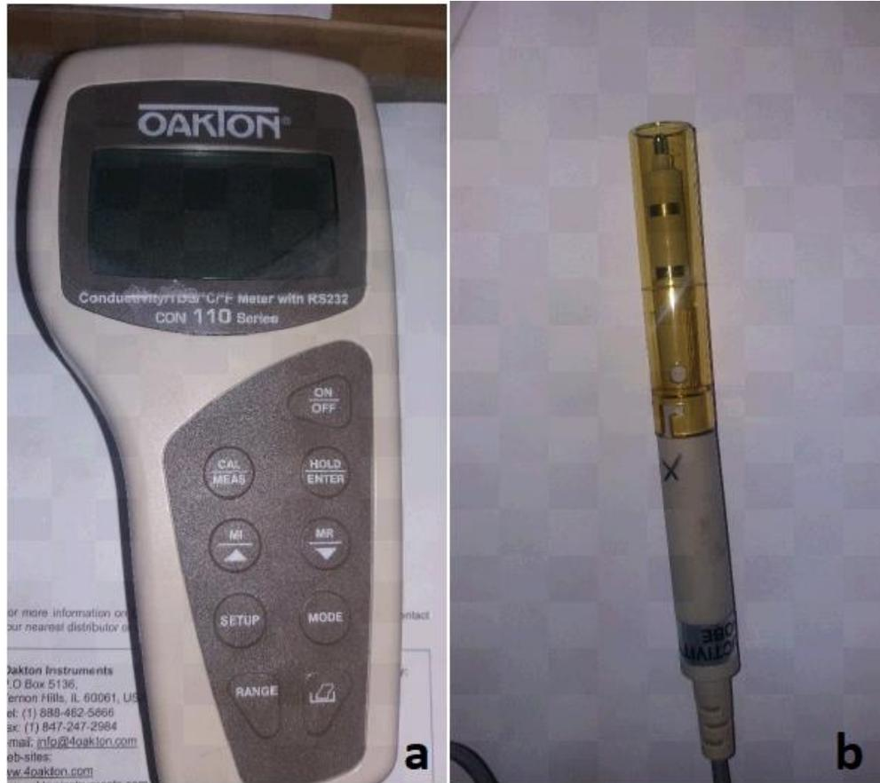
*Figura 5: Medidor de Conductancia y Sales Totales Disueltas Oakton CON 110
