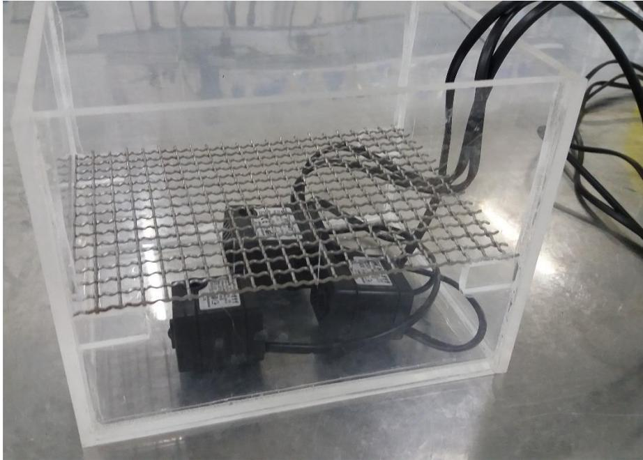
Figura 8: Disposición de bombas y rejilla.
