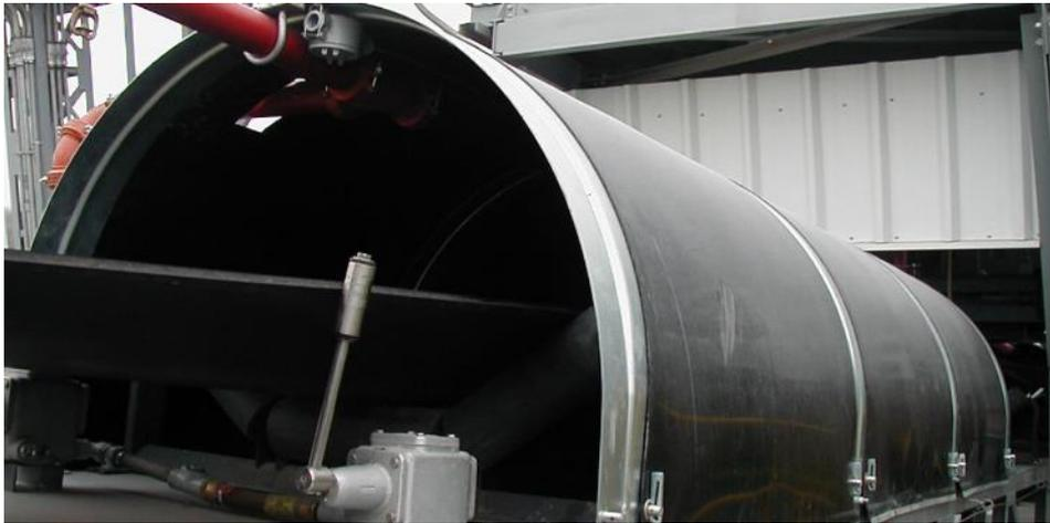
Figura 23. Cubiertas de cinta transportadora
