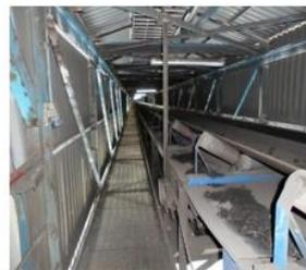
*Imagen 2: interior banda transportadora*
