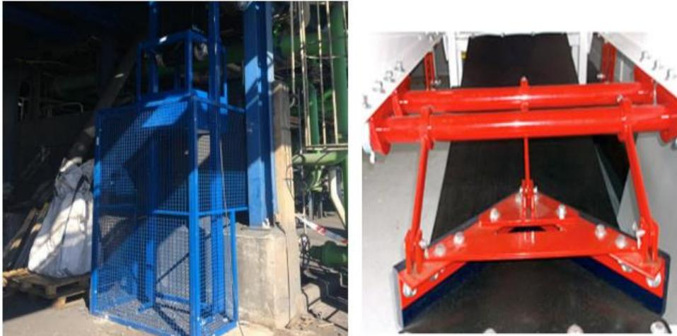
Figura 19. Tensores de gravedad (Contrapesos)
