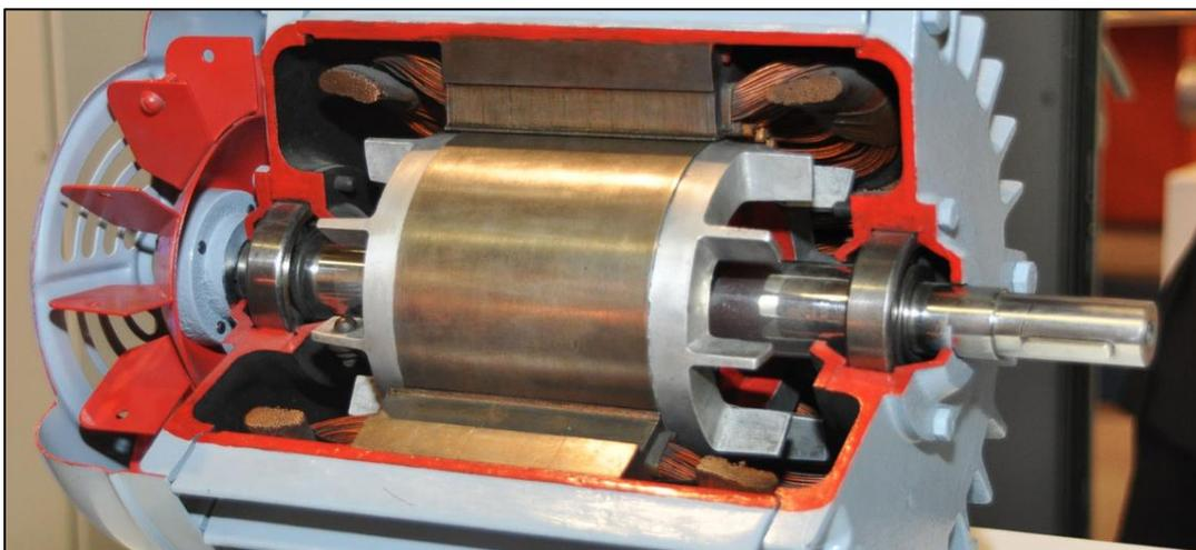
Figura 24. Motor eléctrico.
