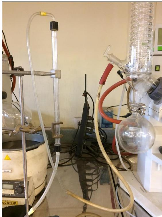
*Figura 4-4: Conexión de flujómetro de bola a Evaporador Rotatorio*
