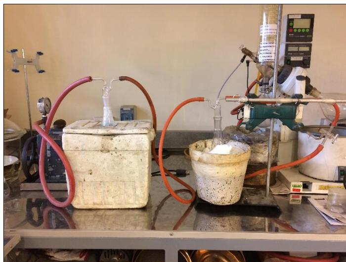
**Figura 4-2: Estaciones de Condensación**
