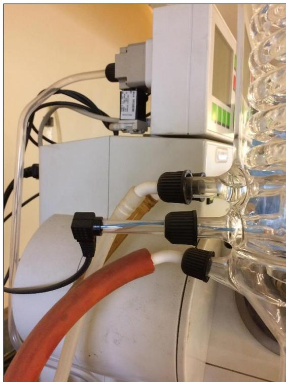
**Figura 4-3: Conexión de mangueras de agua y vacío al Evaporador Rotatorio**
