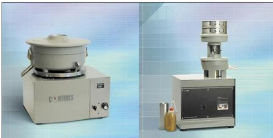
**Figura 4-6: Equipos centrífugos utilizados**
