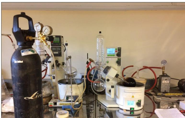
**Figura 4-7: Montaje del Sistema Evaporador Rotatorio utilizado**
