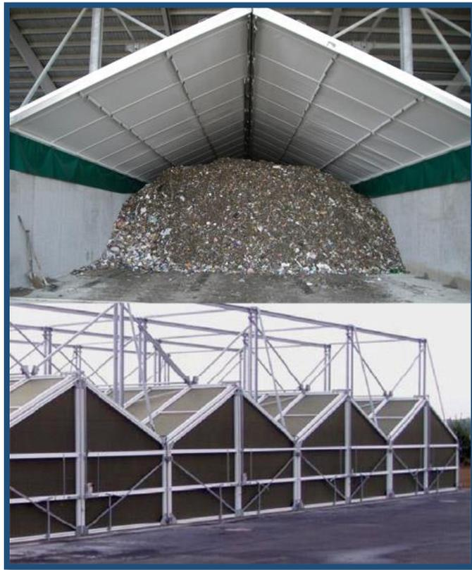
*Ilustración 25: Túneles de compostaje con membrana semipermeable. [15].
