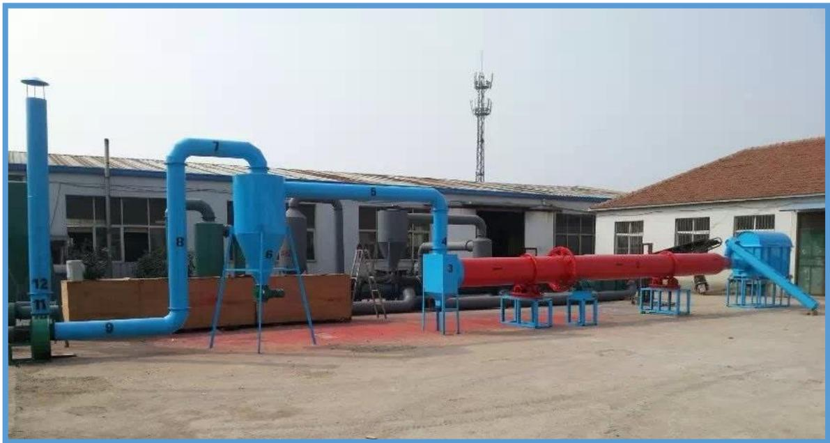
*Ilustración 33: Esquema de instalación de ventilador, ductos, ciclón y secador rotatorio.*
