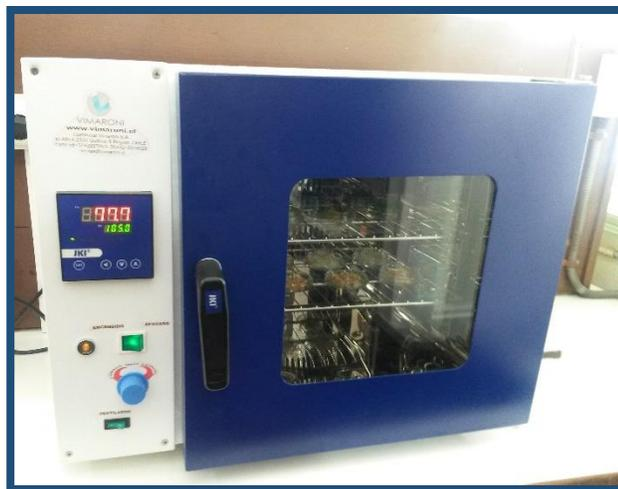
*Ilustración 35: Estufa de secado.*
