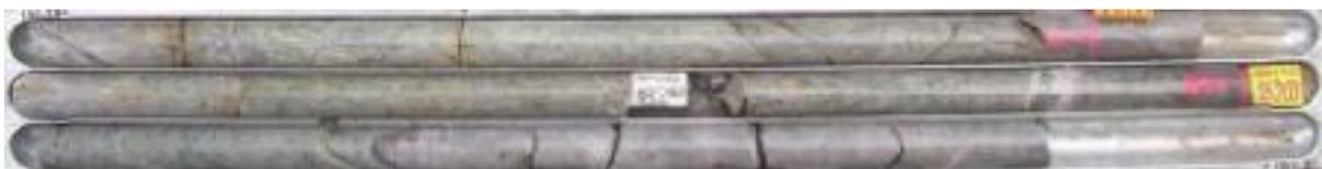
Figura 2.3: Muestra correspondiente a zona primaria (sulfuros), roca PTO. Bandeja 48, tramo 180,25m-184,21m. Fuente: Muñoz, 2019.
