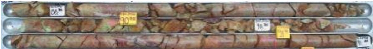
Figura 2.2: Muestra correspondiente a zona secundaria (óxidos), roca PTO. Bandeja 23, tramo 88,60m-91,85m. Fuente: Muñoz, 2019.
