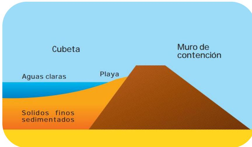
Figura 2.1 Sección típica de una presa de relaves. (Sernageomin, 2003)<sup>(43)</sup>
