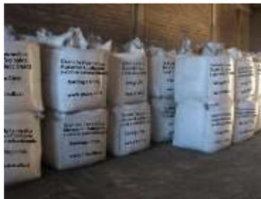
**Ilustración 8: Maxi-saco de 2000 kg de granalla de escoria de cobre**
