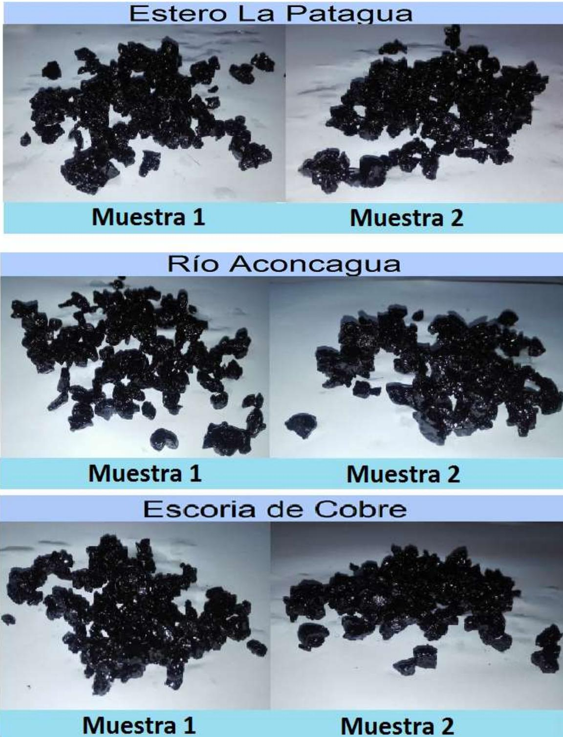
Ilustración 39: Resultados Adherencia por método dinámico
