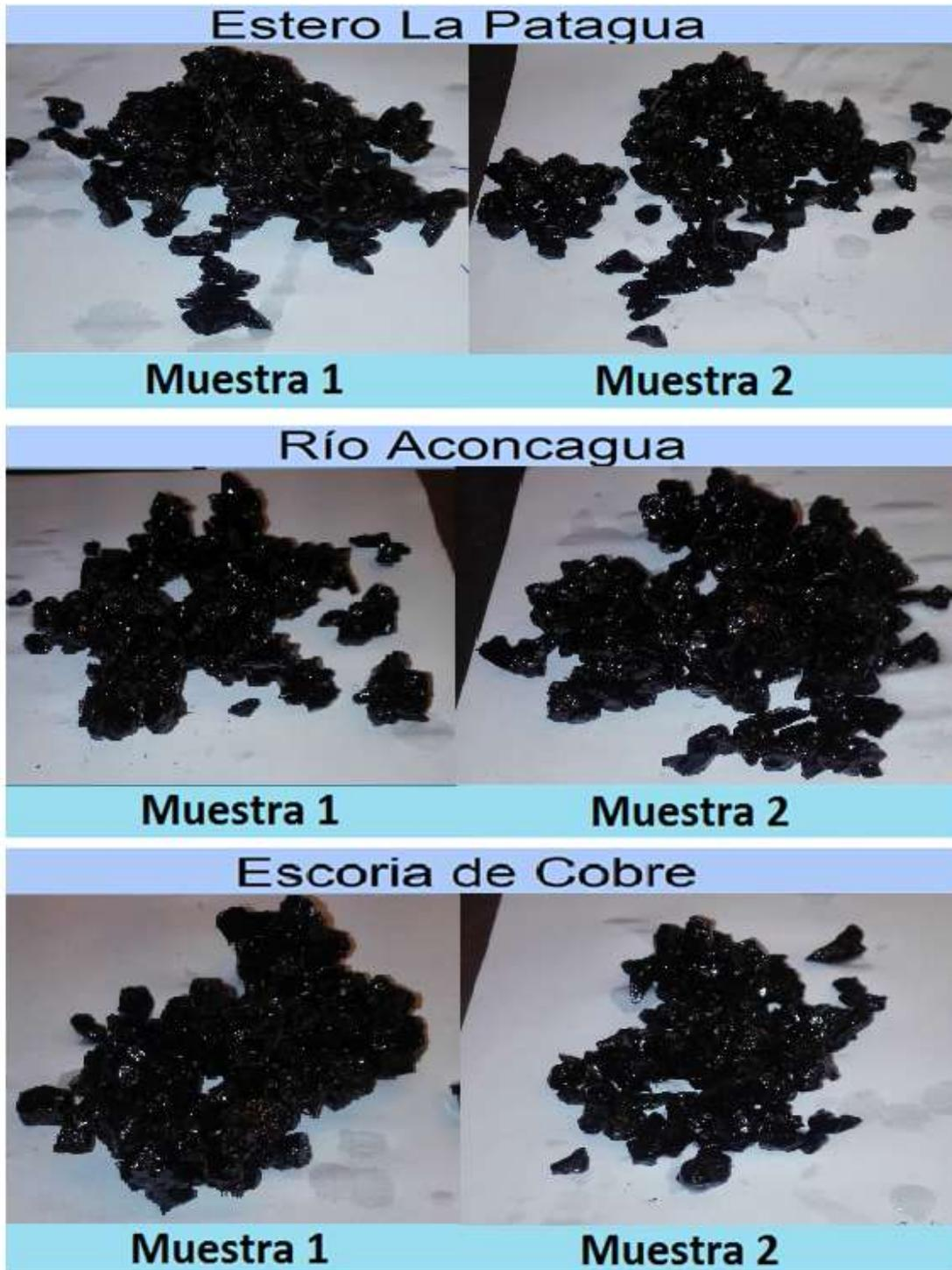
Ilustración 38: Resultados Adherencia por método estático
