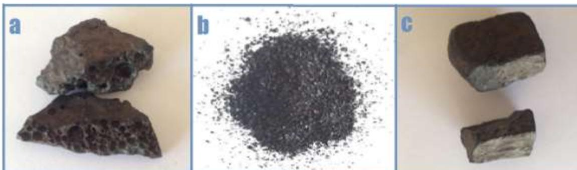
**Ilustración 7: Tipos de escoria de cobre según modo de enfriamiento**
