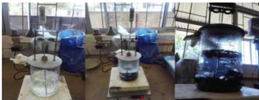
Ilustración 31: Proceso de ensaye por Método del Hervido
