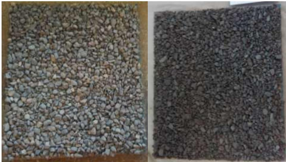
**Ilustración 35: Dosificación de árido según granulometría del Estero La Patagua**
