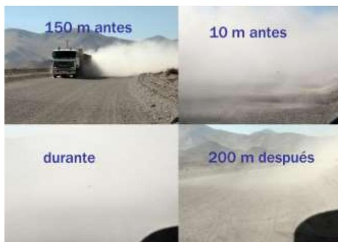
Ilustración 16: Efecto de la emisión de polvo en la seguridad vial
