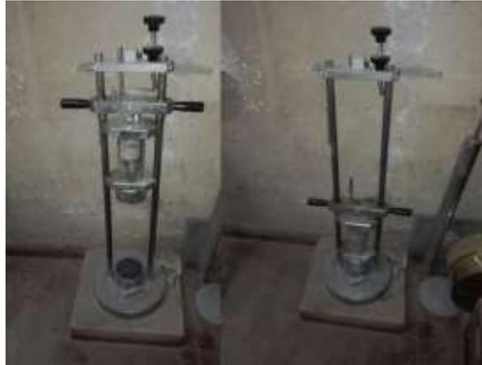
**Ilustración 34: Máquina para impacto para áridos finos**
