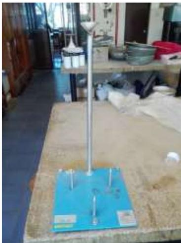
**Ilustración 32: Dispositivo de ensayo Placa Vialit**
