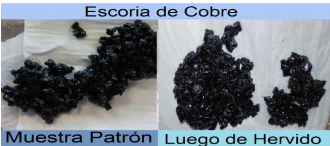
Ilustración 40: Resultados Adherencia por método del hervido
