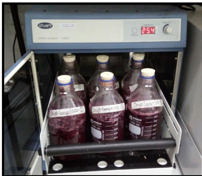
Figura 3-3: Fermentadores 1[L] con mosto de distintos tratamientos de orujo
