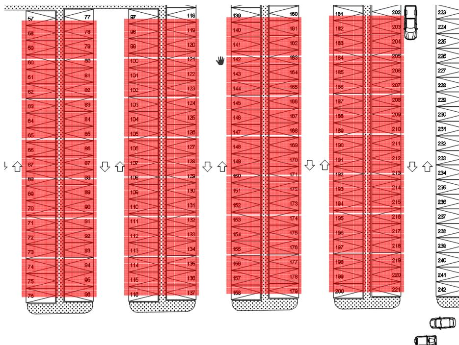
FIG. 30 LAYOUT ACAD COBERTURA DE PANELES FOTOVOLTAICOS EN ESTACIONAMIENTOS [ FUENTE: ELABORACION PROPIA ]
