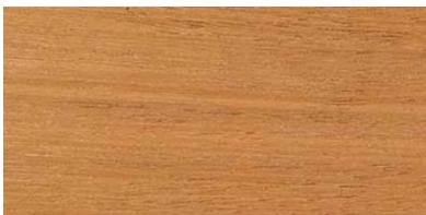
El cedro es una **madera blanda** de color rojizo, muy conocida por su olor dulce. El cedro es ampliamente utilizado en cajoneras, cubiertas y tejas. Se usa mucho en la construcción, para forrar muebles, etc.
