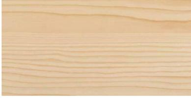
Madera ligera y blanda, comparable con el pino. Peso relativamente bajo con buena resistencia y elasticidad. Fácil de trabajar en todos los aspectos. Relativamente a los químicos es mucho más resistente de que la mayoría de las maderas. Libre de resinas. Se utiliza mucho en la construcción de revestimientos de pared y techo para el interior.
