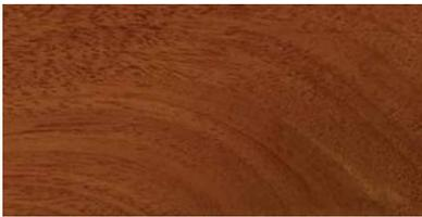
Esta madera de grano fino muy resistente tiene un hermoso color marrón rojizo. Es una de las preferidas en ebanistería ya que en gran parte se emplean para muebles de calidad, como armarios, revestimientos de madera y chapas. Debido a su propiedad de alta densidad y durabilidad es muy empleado en zonas tropicales que tienden a alta humedad.
