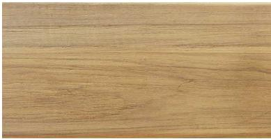
La teca es una madera dura y resistente a la humedad. La teca resiste a deformaciones, fisuras y deterioro y que se utiliza mejor en muebles finos, puertas, marcos de ventanas, pisos y construcción en general. La teca es especialmente utilizada en muebles de exterior y zonas más húmedas.
