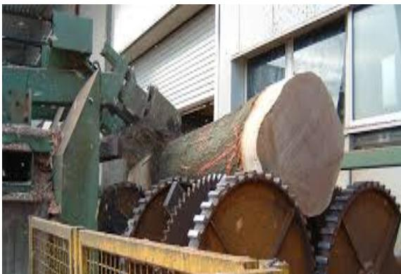
**Ilustración 6 Descortezado mecánico con maquina descortezadora**
