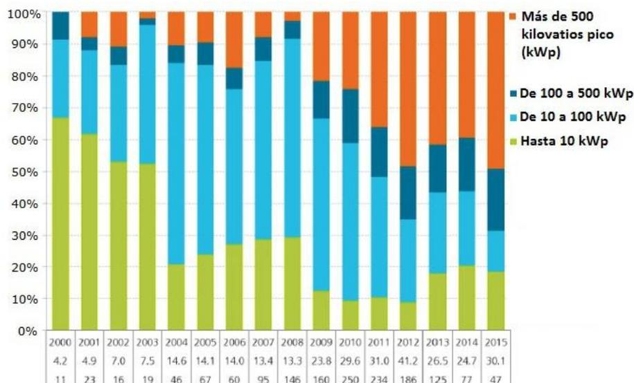
**Figura 10: Distribución, según su tamaño, de las centrales fotovoltaicas instaladas anualmente en Alemania.**
