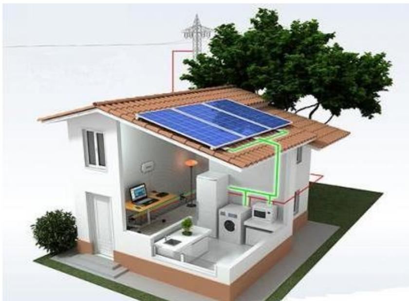
**Figura 1: Componentes autoconsumo de conexión a red.**
