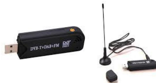
Figura 12 - Sistema de recepción RTL-SDR.
