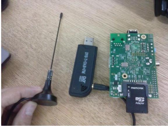
Figura 13 - Sistema de recepción RTL-SDR junto con sistema Raspberry PI modelo B.
