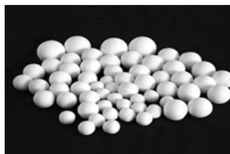
Figura 3.14: Alúminas( $Al_2O_3$ )
