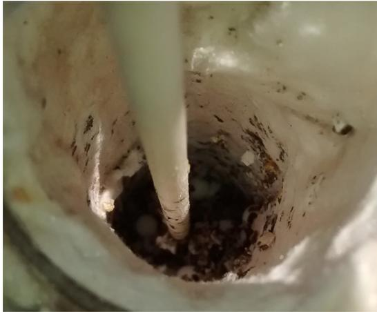
Figura 5.26: Aglomeración de ceniza en el reactor
