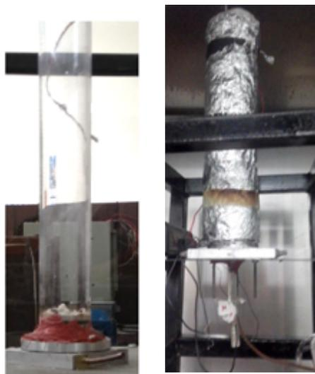
(a) Tubo de cuarzo (b) Reactor de medios porosos
