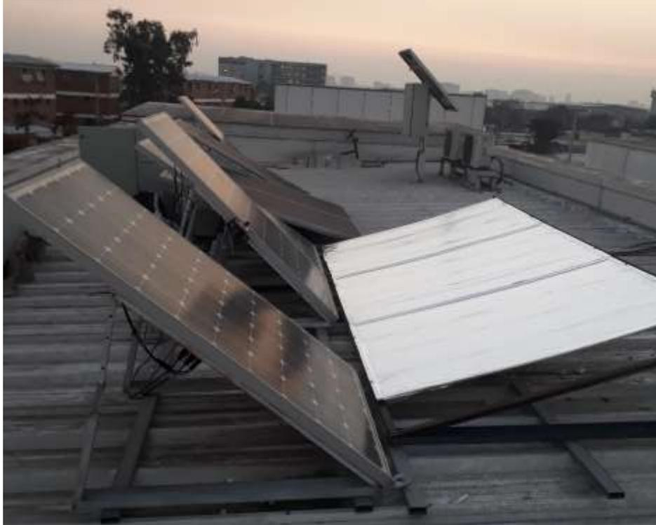
*Figura 4.11 Panel PV con reflector de aluminio.*
