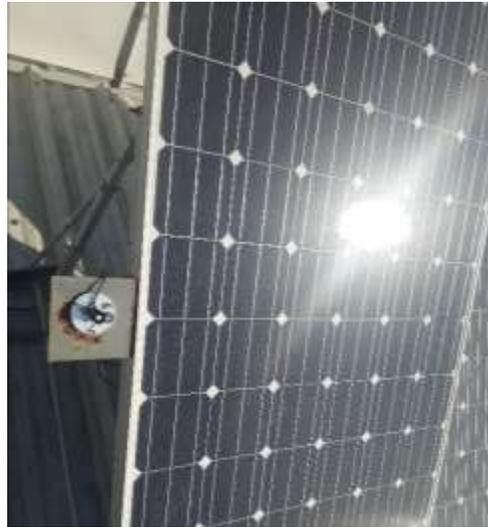
*Figura 4.10 Piranómetro utilizado en panel PV con reflector.*
