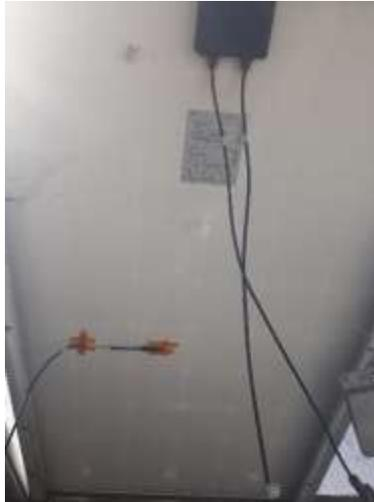
*Figura 4.8 Ubicación del termistor en el panel PV.*
