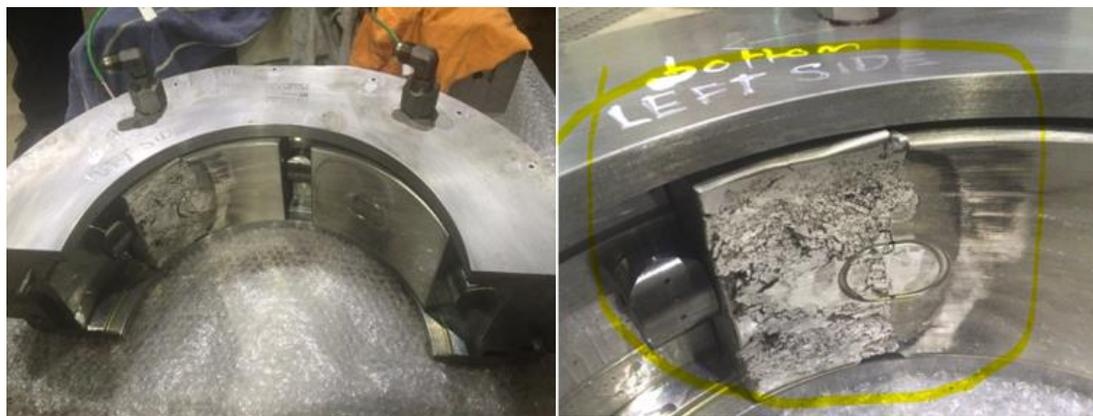
Luego de realizar la inspección del cojinete y encontrar los daños que se muestran en la figura 25, se decide investigar la causa raíz del daño, el diagrama Ishikawa que se muestra en la figura 27 representa el árbol causa y efecto que representa la falla.
