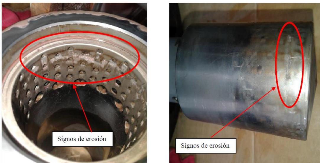
El canastillo de la válvula al igual que el obturador evidencia signos de erosión, lo cual explica el aumento de flujo de agua a pequeños incrementos de posición de la válvula de agua de alimentación.
