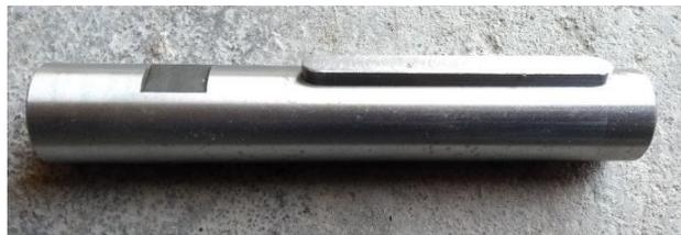
*Figura 4. 1 Fabricación de eje y chaveta*
