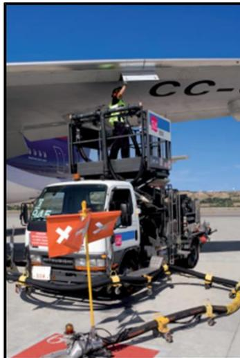
Fig 5.5: Carguío de combustible de un avión por medio de un camión dispensador en un aeropuerto de España.<sup>12</sup>
