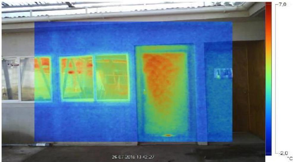
Figura 1-7 Fotografía de cámara termográfica en puertas y ventanas pabellón 1
