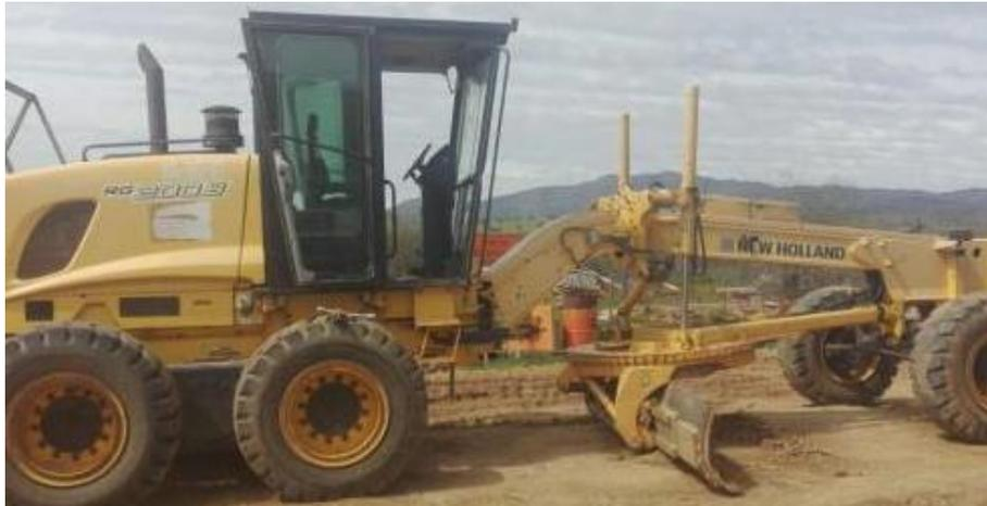
Figura 2-6. Motoniveladora New Holland RG 200b.
