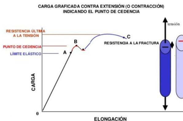
Figura 3-5.- Resistencia ultima del material
