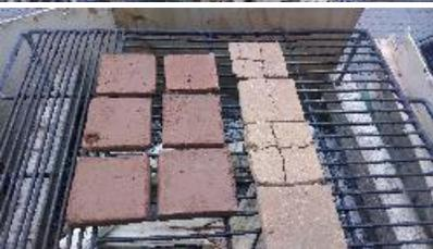
El fuego se coloca en un punto central del elemento para no traspasar los bordes con llamas, se mide en el punto directo donde se aplica la llama y paralelamente se toma la temperatura en la cara posterior, registrando el tiempo en llegar a los 220°C.
