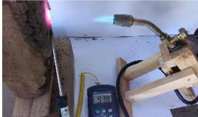
Para ambos tipos de ensayos, se dará por finalizada la medición cuando el material sufra agrietamientos durante el proceso, independientemente del tiempo que este hubiese demorado llegar al colapso. Usualmente el colapso de la muestra sucede cuando son aplicadas cargas para medir su resistencia estructural, pero en el caso de los materiales heterogéneos, las fallas están directamente relacionadas a su composición material o preparación de la muestra.
