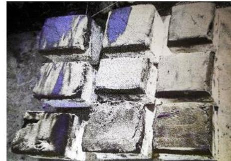
Solo por observación y de acuerdo con los resultados obtenidos de cada una de las muestras antes probadas, una vez terminado el tiempo correspondiente a cada muestra fue retirado el revestimiento para visualizar las condiciones en las que se encontraba el Panel SIP.
