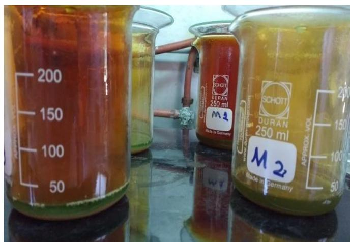
Figura B-2. Muestras de concentrado de cobre repartidas en recipientes de teflón para DAAM para determinación de Cu
