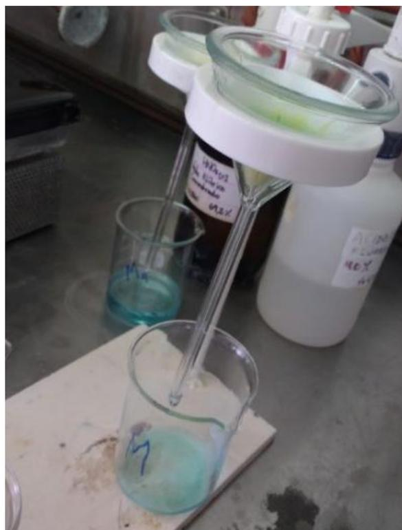
Figura B.3 Anillo azul característico ocasionado por la adición de  $\text{NH}_3$  causando precipitación del hierro en solución.
