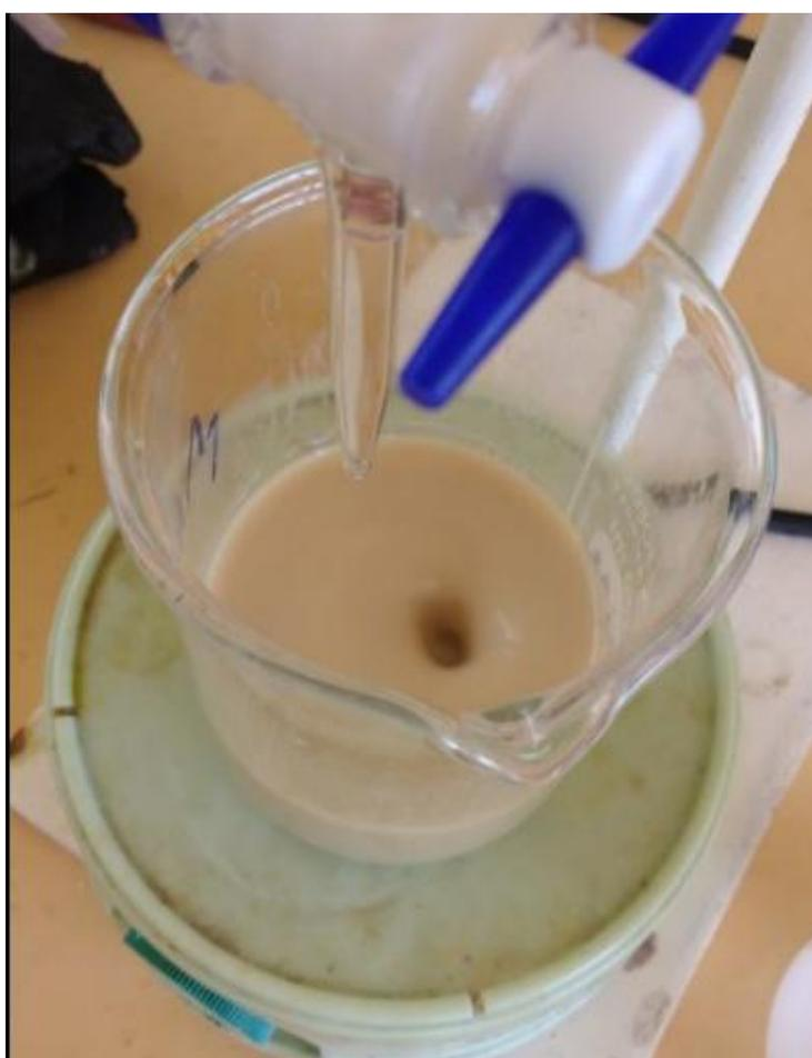
Figura B-7. Muestra OREAS 991 después de ser sometida a calcinación para determinación de oro
