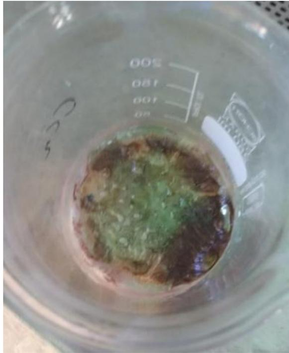
Figura B-2. Filtración de precipitado de OREAS 934 por medio de DAAM.
