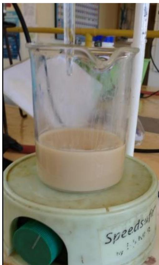
Figura B-5. Cu en solución valorado con  $\text{Na}_2\text{S}_2\text{O}_3 \cdot 5\text{H}_2\text{O}$ , punto inicial en DAAM
