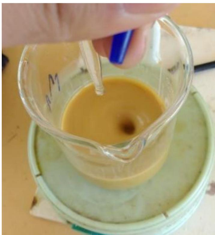
Figura B-6. Cu en solución valorado con  $\text{Na}_2\text{S}_2\text{O}_3 \cdot 5\text{H}_2\text{O}$ , punto final en DAAM
