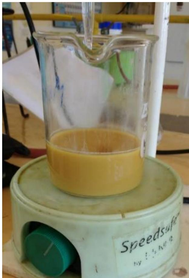
Figura B-4. Cu en solución valorado con  $\text{Na}_2\text{S}_2\text{O}_3 \cdot 5\text{H}_2\text{O}$ , punto final en DT
