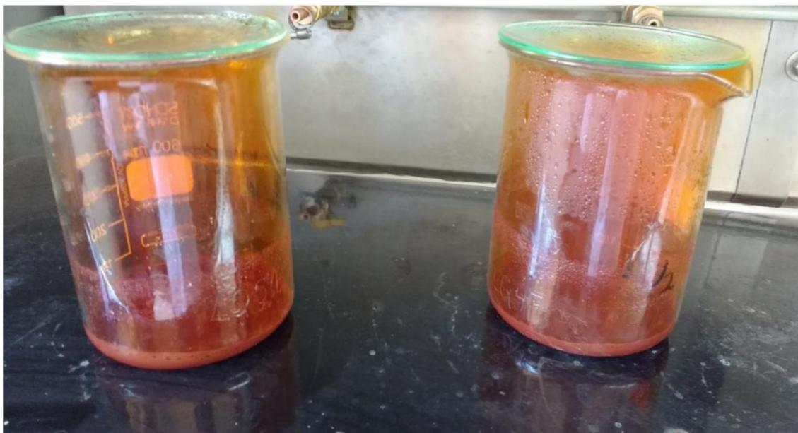
Figura B-9. Disposición de recipientes de teflón para determinación de oro por DAAM
