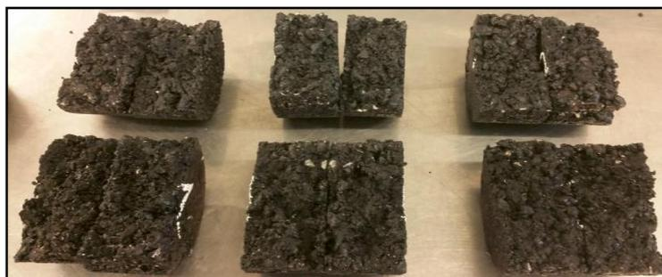
**Ilustración 3-14: Inspección visual verificando desprendimiento de árido-ligante asfáltico en ambos grupos.**
