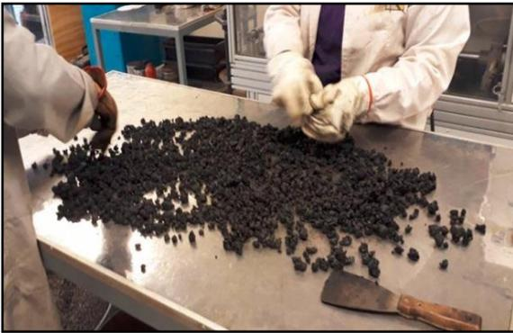
**Ilustración 3-5: Desprendimiento de partículas para obtener la máxima densidad de la mezcla suelta**
