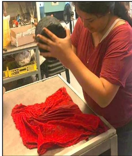
**Ilustración 3-9: secado superficialmente seco.**
