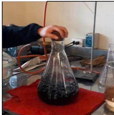
**Ilustración 3-7: Eliminación de vacíos de aire.**
