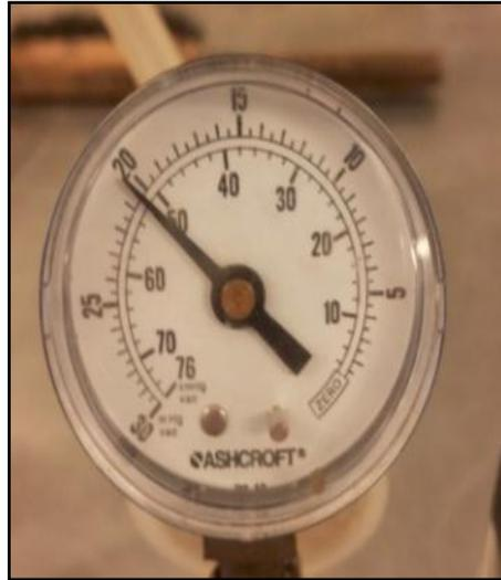
**Ilustración 3-11: Saturación de probeta a una presión de 20[in. Hg] durante un tiempo de 5 [min].**
