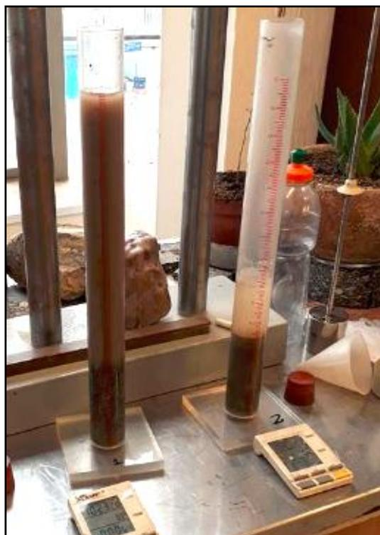
**Ilustración 3-2: Procedimiento para el ensayo de contenido de arcilla.**
