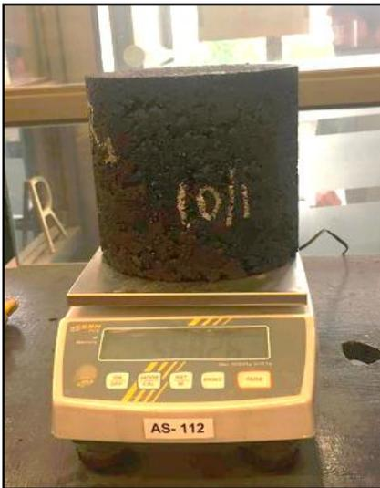
**Ilustración 3-8: Determinación del Peso del espécimen en seco**
