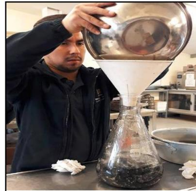
**Ilustración 3-6: Vaciado de la mezcla en matraz.**
