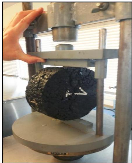
**Ilustración 3-13: Acondicionamiento de probetas a 25[°C] por media hora previo a realizar ensayo de tracción indirecta.**
