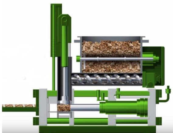
*Figura 2-5, Briquetadora hidráulica*
