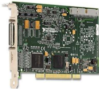
Figura 2.14: Tarjeta adquisidora de datos
