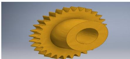
FIGURA 2-10. Sprocket Conducido
