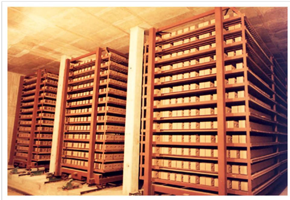
*Figura n°9 Vagonetas cargadas con productos en un secadero.*
