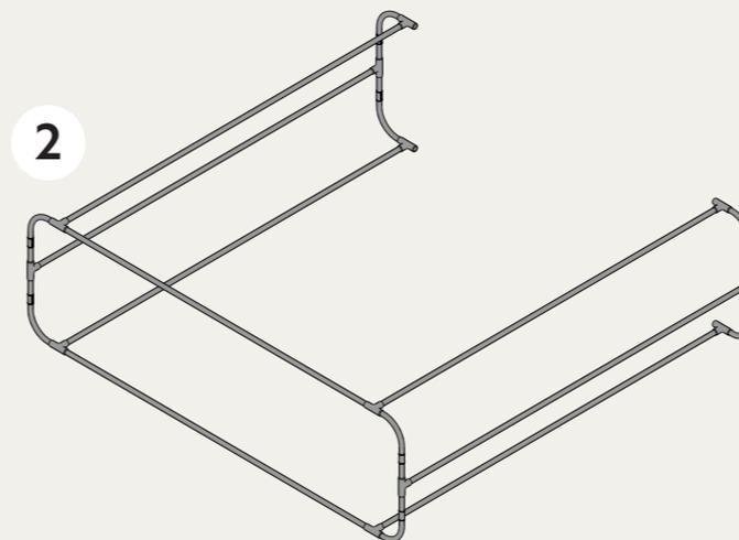
Alineadas las secciones se colocan los tubos emt, para ser fijados con un destornillador apretando las abrazaderas quedando la estructura similar a lo presentado en la **Etapa 2**.
