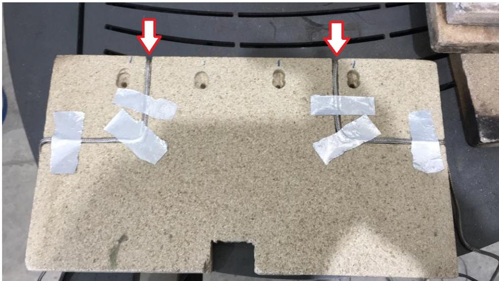
Figura 17: Intervención de vermiculita mediante canales y perforaciones, las flechas indica el lugar donde se perfora y posiciona la termocupla dentro de la vermiculita
