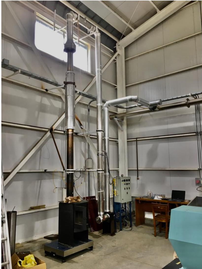
Figura 10: Entorno de pruebas, vista general del túnel de dilución montado en Sede JMC, UTFSM
