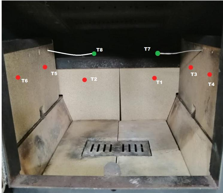
Figura 18: Disposición termocuplas para ensayo linea base
