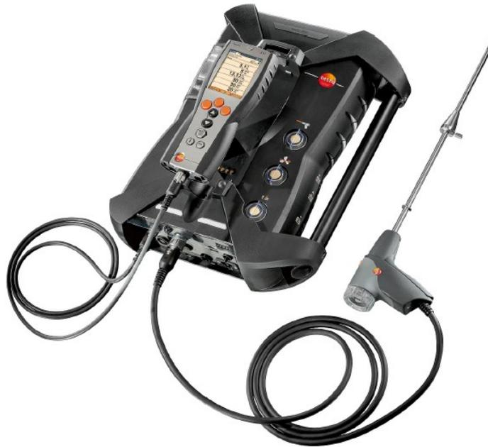
Figura 14: Analizador de gases Testo 350
