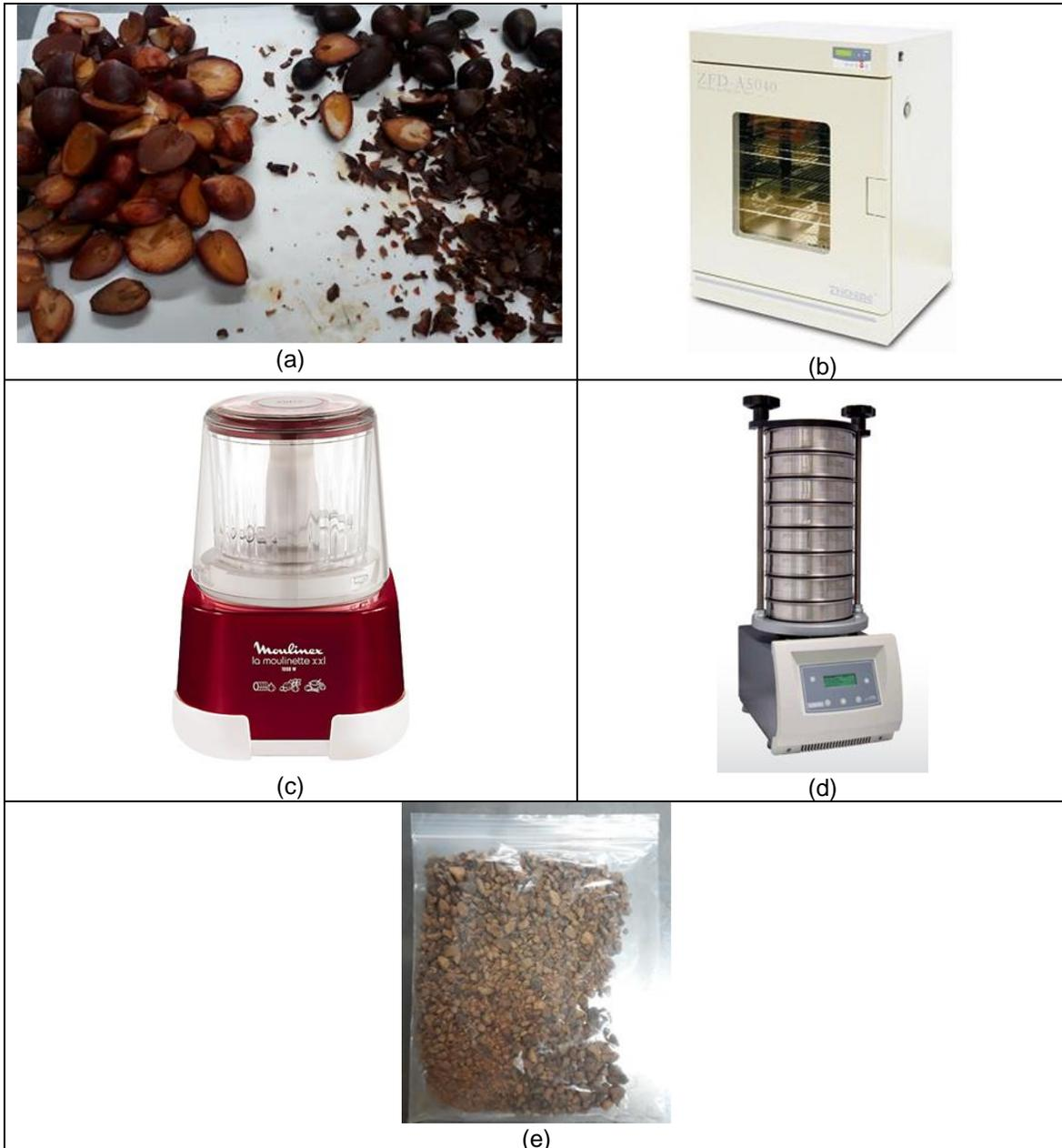
*Figura 4.1-1: Resultados y equipos utilizados en pretratamiento de biomasa (a) hueso de palta sin tegumento (izq.) y residuo de la etapa (der.); (b) Estufa convectiva marca ZHICHENG modelo ZXFD-A5040 (Fuente: [www.zhichengyq.com](http://www.zhichengyq.com)); (c) Procesadora 1,2,3 Moulinex, DP800 (Fuente: [moulinex.cl](http://moulinex.cl)); (d) Tamizadora Orto Alresa OASS 203 (Fuente: <http://www.mainsolutions.eu>); (e) Almacenamiento de biomasa en bolsa plástica hermética.*
