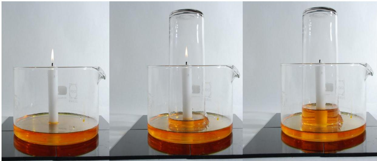
Figura 1.1: Experimento de necesidad de aire para la combustión.
