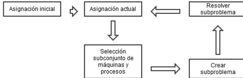
**Figura 3.2:** Funcionamiento general del algoritmo LNS.
