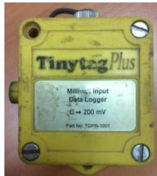
Figura 55: Data logger de voltaje TinyTagPlus
