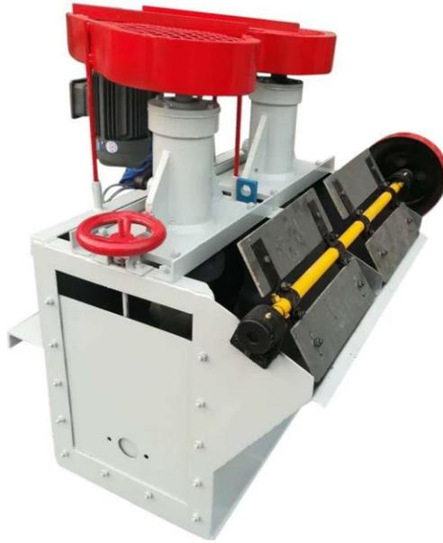
*Figura 6: Celda de Flotación 911MPESF-1.2*
