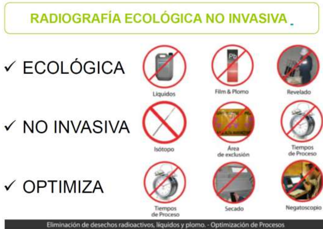
Figura 3-3: Ventajas radiografía computarizada y digital
