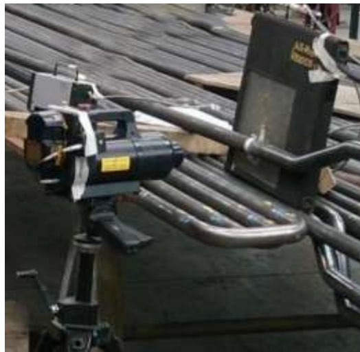
Figura 2-7 - Exposición radiográfica con posicionamiento mixto.
