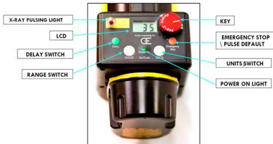
Figura 3-6: Esquema de control equipos XRS
