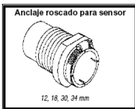
Figura 4-4: Anclaje del sensor Capacitivo.
