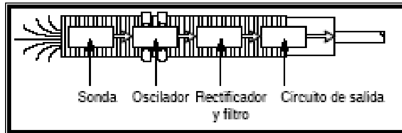
Figura 4-2: Esquema de funcionamiento del sensor capacitivo.
