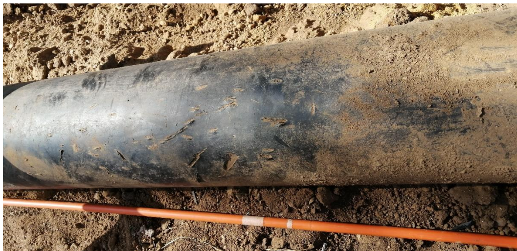
Figura 1-1. Red con fallas en el revestimiento
