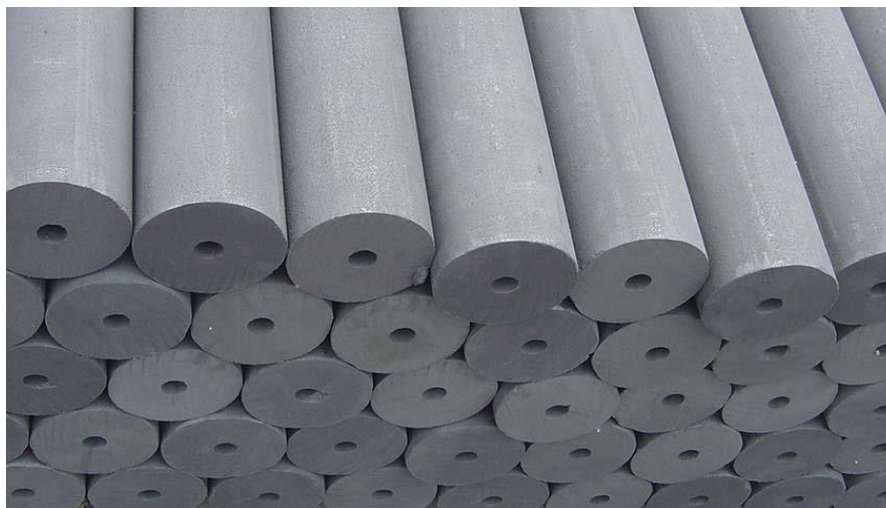
Figura 2-7. Ánodo de grafito impregnado.
