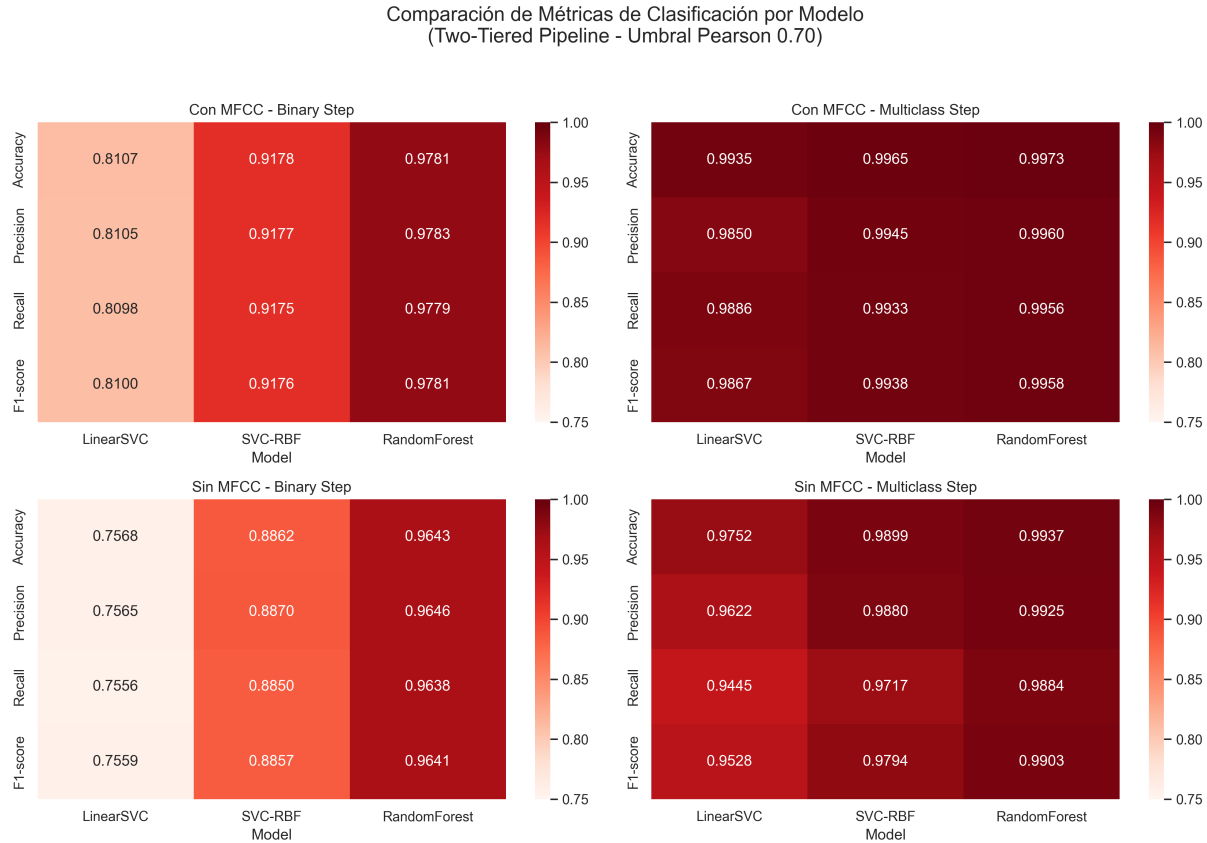
Figura 4.6: Heatmap de métricas para pipeline two-tiered. Arriba: con MFCC, abajo: sin MFCC. Umbral Pearson 0.70.
