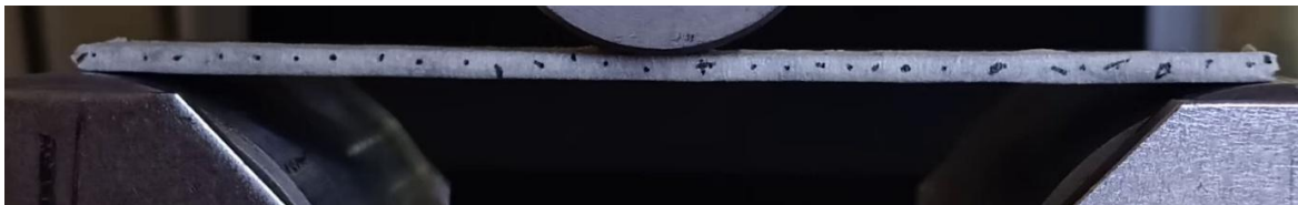
Ilustración 21: Probeta acero MN65 con patrón para contraste en DIC.
