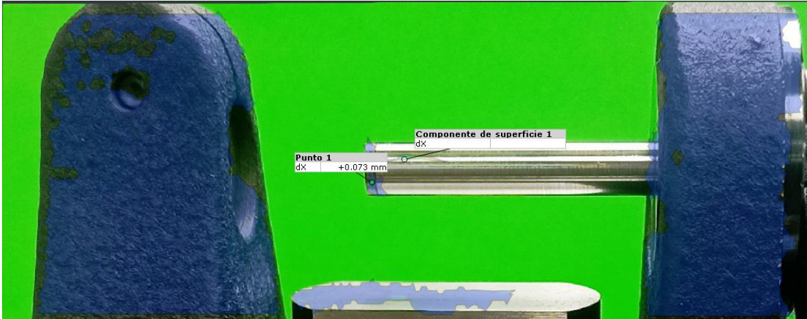
Ilustración 8: Análisis desplazamientos en micrómetro software DIC.
