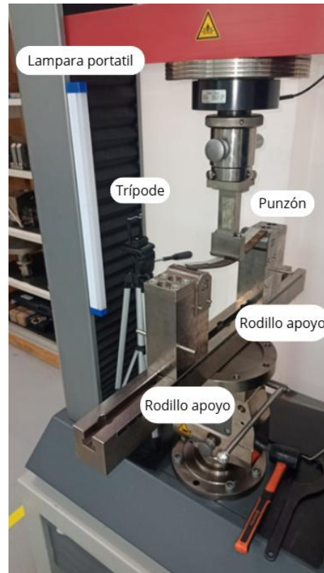
Ilustración 20: Setup final DIC.
