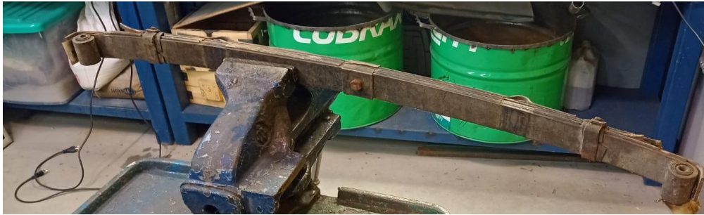
Ilustración 16: Proceso de desmontaje ballesta automotriz.
