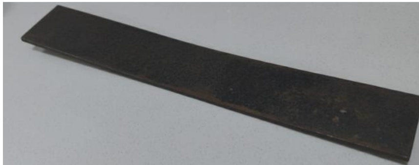
Ilustración 17: Probeta de ballesta automotriz Fiat126.
