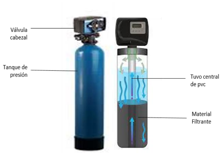
Figura 1-9. Filtro de lecho profundo
