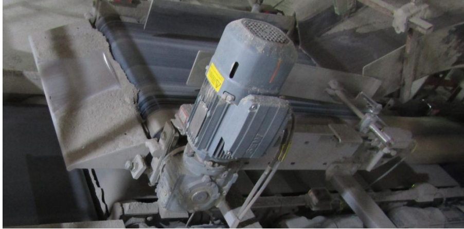
Figura 4-17 Equipo cadenciador con transmisión de potencia por machones de acople
