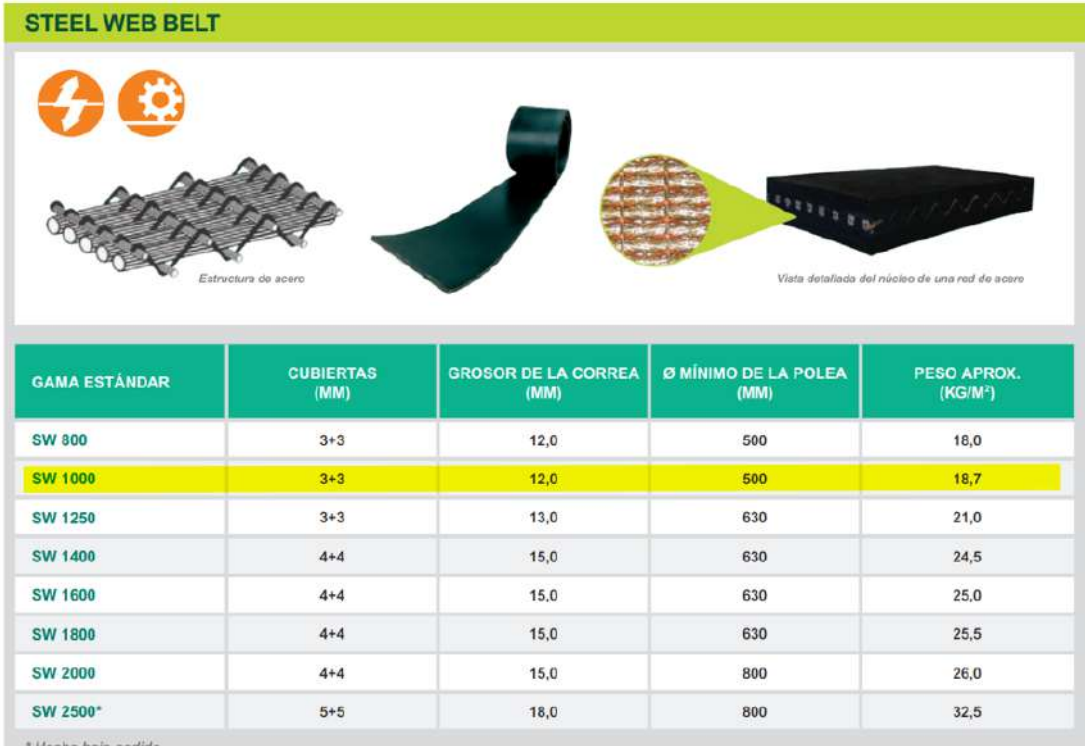
Figura 44: Propiedades de correa con alma de acero SW1000 [50]
