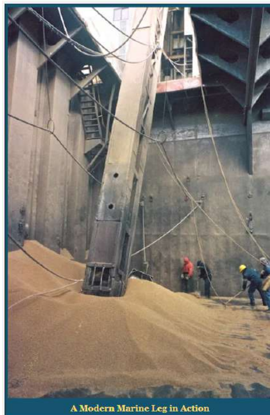
Figura 5: Ejemplo de estructura de torre marina o “marine leg” moderna descargando granos de un barco [17].
