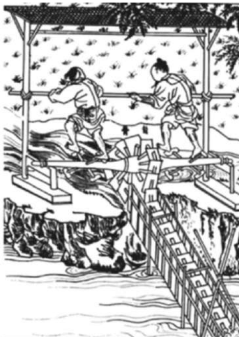
Figura 2: Elevador de cangilones chino impulsado manualmente [6].
