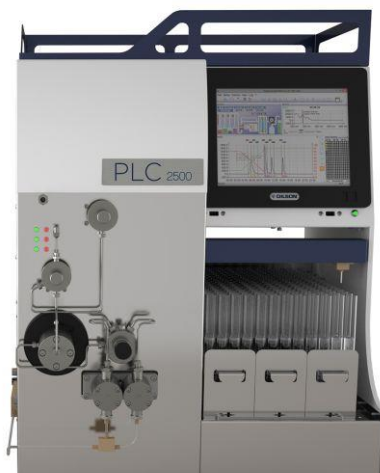
Figura 1-9: Sistema de purificación de PLC
