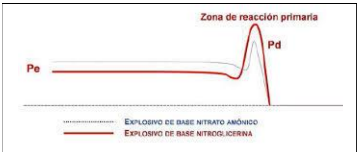
Figura 4: Presión de detonación (Pd) y presión de burbuja (Pe) de dos tipos de explosivo
