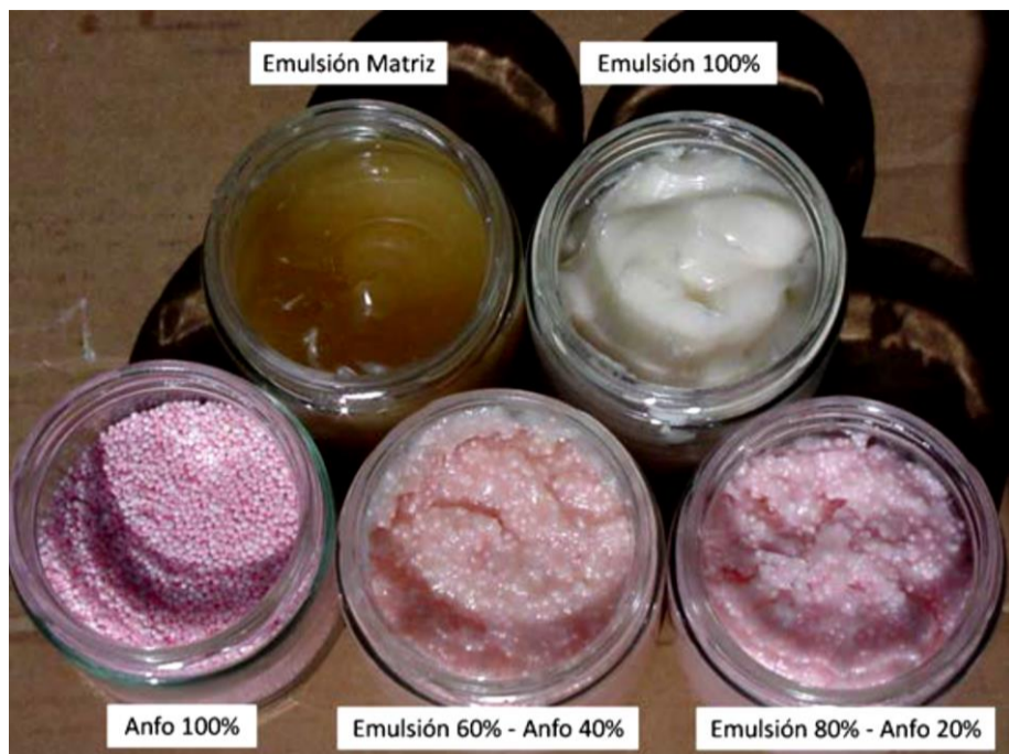
Figura 30: Diferentes tipos de emulsión en función de la proporción Emulsión/Anfo
