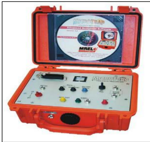
Figura 8: Equipo de medida continua de velocidad de detonación. Fuente (MREL)
