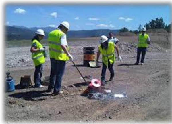
Figura 52: Destrucción de explosivos por combustión. Fuente (polminera.com)
